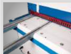
Pracovní stůl s podpěrnými rameny a přepravními kuličkami
