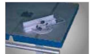
▶ Ukazatel napnutí pilového pásu pro různé šířky pásu.
