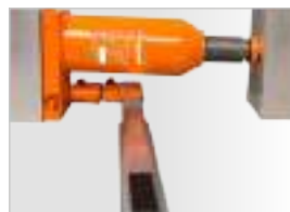
▶ Zvedák lze použít ve svislé i vodorovné poloze
