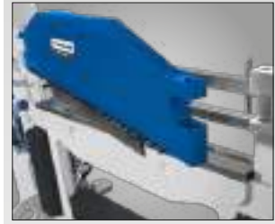
▶ Uzavřené obrobky lze tvářet otevřením horního nosníku
