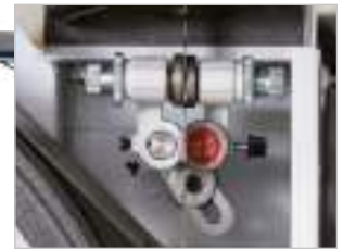
▶ Přesné tříkladkové vedení pilového pásu s vodicími kladkami s jemným nastavením.
