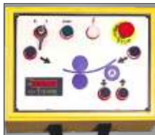
Digitální odměřování zadního válce (volitelné příslušenství)
